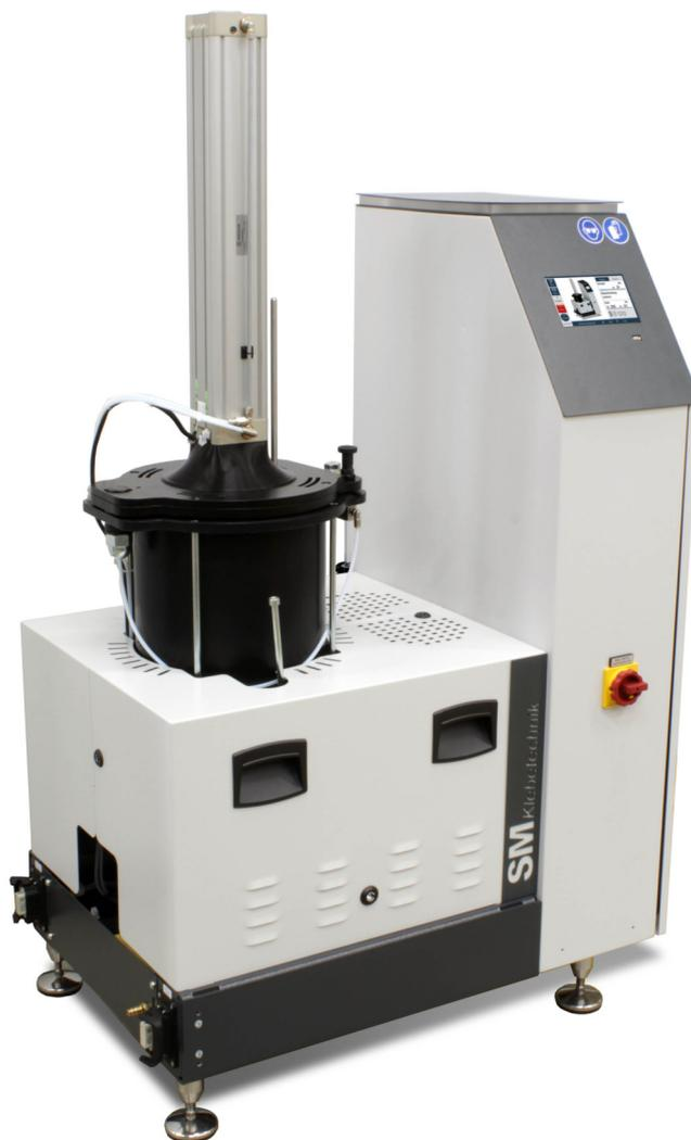
Effizientes und wartungsfreundliches Beutelpressgerät GR21 zum schonenden Verarbeiten und Dosieren von durch Feuchtigkeit vernetzenden Hotmelts; mit Reservoir für unterbrechungsfreien Betrieb während des Nachfüllvorganges sowie standardmäßig integrierter Lufttrockner-Schutzbegasung. Die komplette FlexControl-Grundausrüstung umfasst Wochenzeitschaltuhr, Betriebsstunden- und Schaltspielzähler sowie das Rezeptmenü.
