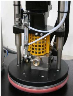
Schmelzplatte mit automatischer Entlüftung
