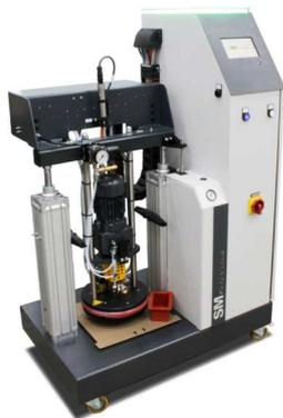
Fassschmelzanlage GX21 mit innovativer FlexControl Mikroprozessor-Steuerung
