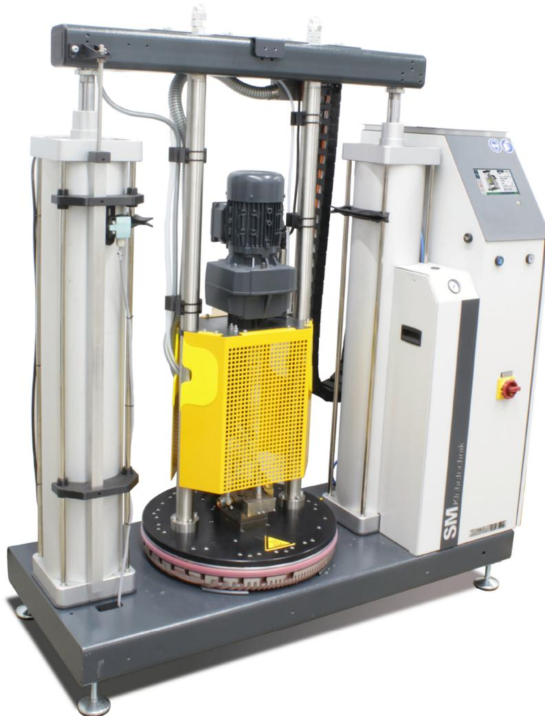
Das Maschinenkonzept besteht aus pneumatischen Druckzylindern und einer beheizten segmentierten Folgeplatte mit Zahnradpumpe in konfigurierbarer Ausführung. Dies gewährleistet einen wartungsarmen Betrieb beim Schmelzen und Fördern von geeigneten thermoplastischen oder reaktiven Kleb- und Dichtstoffen. Eine optimale Bediensicherheit wird mittels diverser Überwachungen und Betriebszustandsanzeigen, sowie einer Zweihand-Bedienung erreicht.
