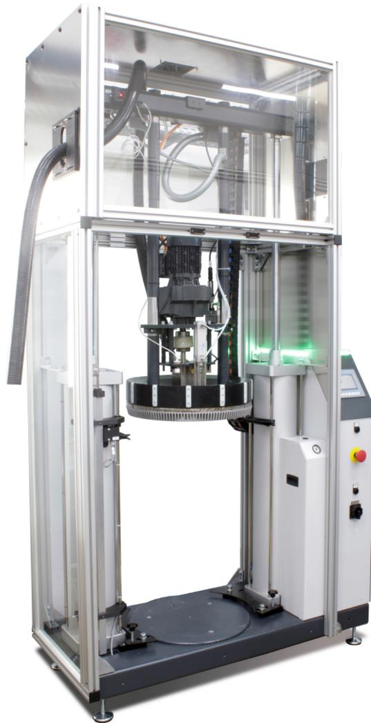
Durch eine permanente Niveauregelung wird die beheizte Tauch-Schmelzplatte, mittels verknüpfter Näherungs- und Druck-Sensoriken zur Mediumfassung, zuverlässig in Höhe und Eintauchtiefe geführt. Das dichtungslose Schmelzplattenkonzept gewährleistet, in Verbindung mit einer Differenzdrucksteuerung der Hubzylinder und einem Wegstreckenmesssystem, einen wartungsfreien Betrieb bei der Förderung geeigneter Materialien bei geringer Restmenge im Faß.
