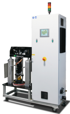
Fassschmelzanlage GX21 mit SPS Siemens Profinet Schnittstelle, Touchscreen Bedienfeld und Signalampel
