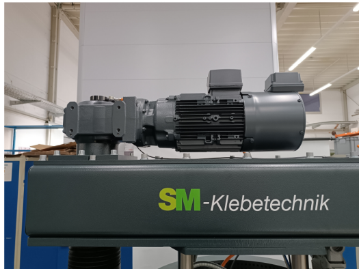
Materialförderung ohne Druckluft mittels elektrischem Spindeltrieb
