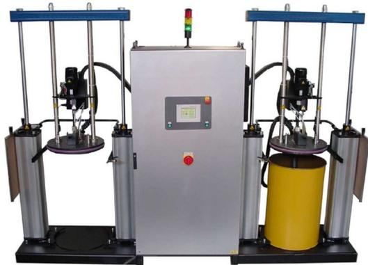
Kundenspezifische Ausführung mit Edelstahlschaltschrank einer GX85 Tandem-Fassschmelzanlage für 200 Liter - Fässer
