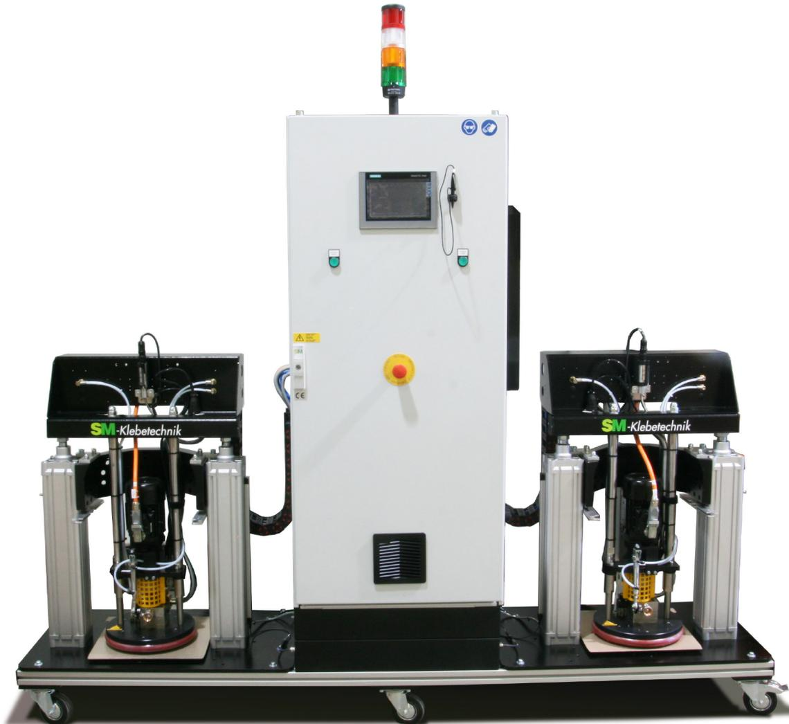
Das Maschinenkonzept bestehend aus pneumatischen Druckzylindern und beheizten antihaft-beschichteten Folgeplatten mit Zahnradpumpen in konfigurierbarer Ausführung, gewährleistet einen wartungsarmen Betrieb beim wechselseitigen Schmelzen und Fördern von geeigneten thermoplastischen oder reaktiven Kleb- und Dichtstoffen. Eine optimale Bediensicherheit wird mittels diverser Überwachungen und Betriebszustandsanzeigen, sowie einer Zweihand-Bedienung erreicht.
