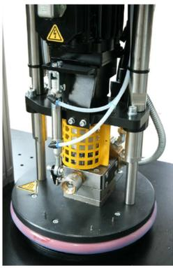
Schmelzplatte mit automatischer Entlüftung
