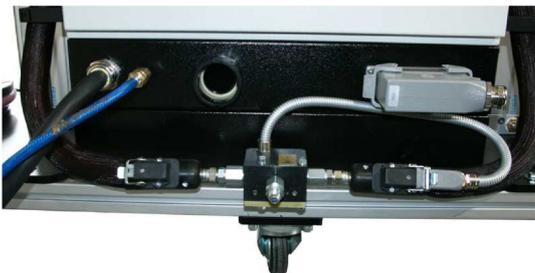
Beheizter Schlauchverteilerblock mit integriertem mechanischem Rückschlagventil im Klebstofffluss
