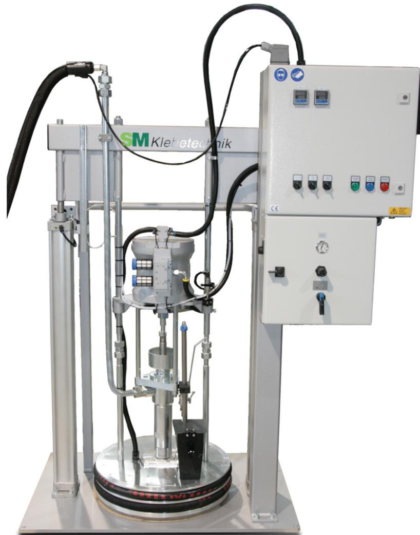
Das Maschinenkonzept bestehend aus pneumatischen Druckzylindern und temperierter Folgeplatte, ausgestattet mit einer Schöpfkolbenpumpe, gewährleistet einen wartungsarmen Betrieb beim Fördern von geeigneten viskosen bzw. pastösen Materialien, die mittels Temperierung eine verbesserte Fließfähigkeit erlangen. Eine optimale Bediensicherheit wird mittels diverser Betriebszustandsanzeigen, sowie einer Zweihand-Bedienung erreicht.
