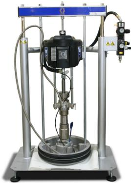
Unbeheiztes pneumatisches Fördersystem mit doppelter Plattendichtung für die Verwendung von Sickenfässern
