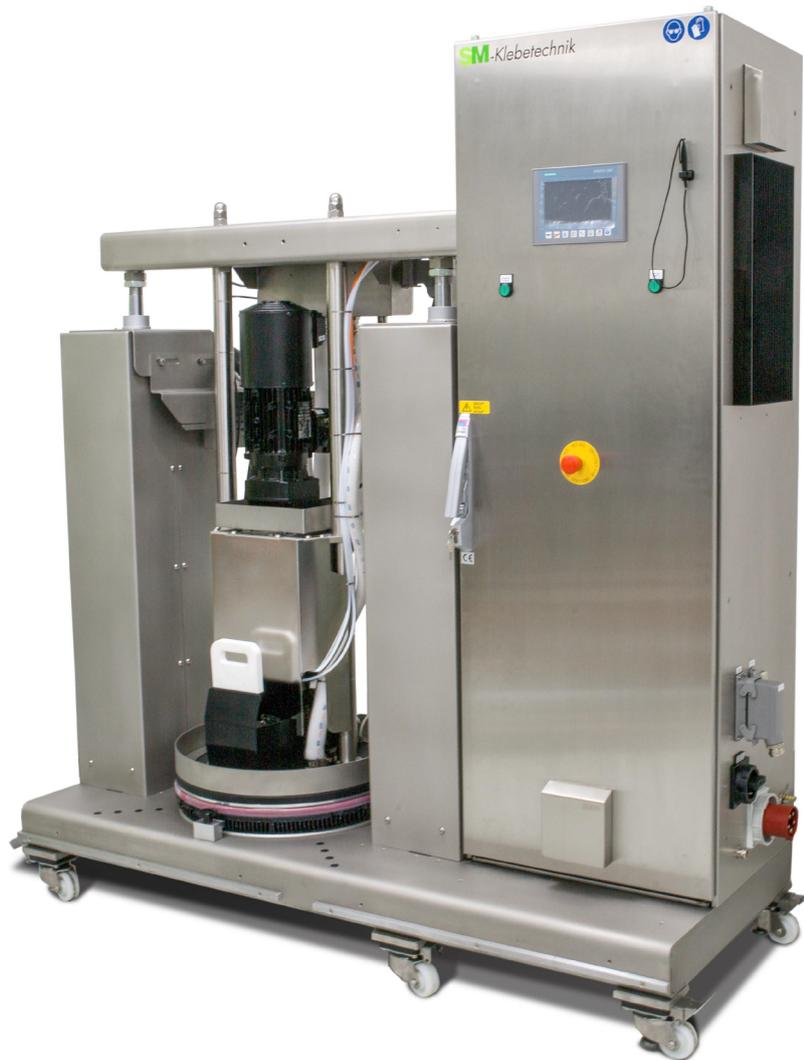
Das Maschinenkonzept bestehend aus pneumatischen Druckzylindern und beheizter segmentierter Folgeplatte mit Zahnradpumpe in konfigurierbarer Ausführung, gewährleistet einen wartungsarmen Betrieb beim Schmelzen und Fördern von geeigneten thermoplastischen oder reaktiven Kleb- und Dichtstoffen. Eine optimale Bediensicherheit wird mittels diverser Überwachungen und Betriebszustandsanzeigen, sowie einer Zweihand-Bedienung erreicht.
