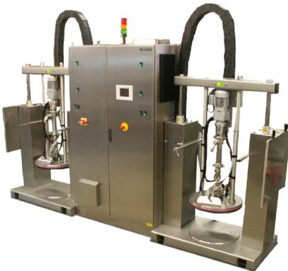
Tandem-Fassschmelzer mit Exzenter-Schneckenpumpen in Edelstahlausführung für unterbrechungsfreien Betrieb
